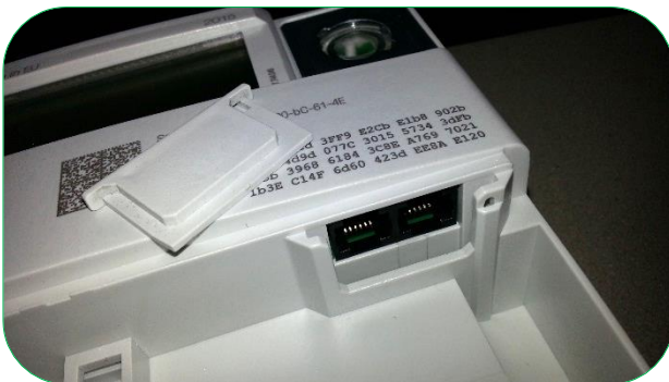
Bild 42: LMN Schnittstelle – Zugang zu RJ-12 Buchsen
