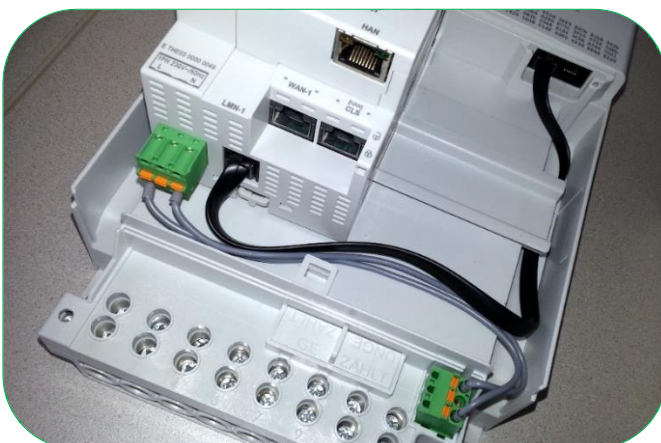
Bild 43: Verbindung SMGw an LMN-1 Stecker
