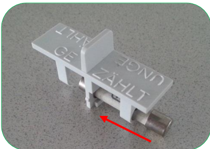
Bild 48: Wechseln von Sicherung
