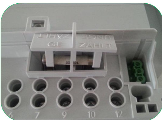
Bild 49: Sicherungsgehäuse mit ersetzte Sicherung wird in die Position gebracht (umgekehrte Reihenfolge als im Bild 47)
