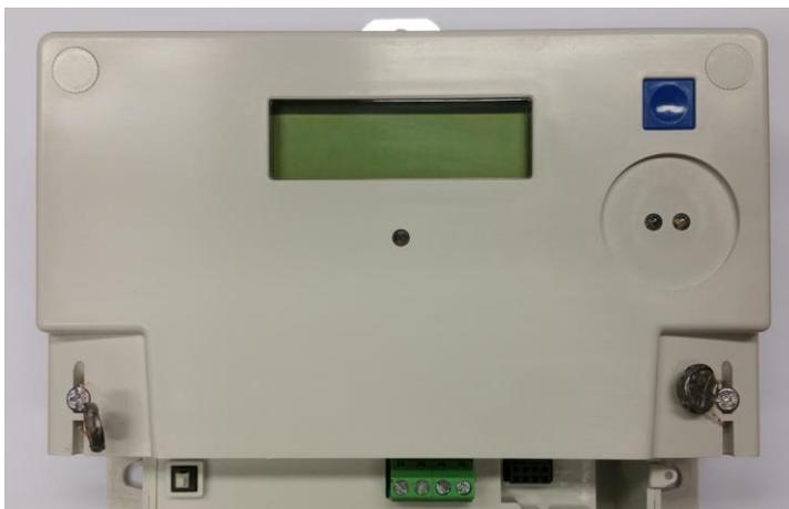
**Fig. 7: Gehäuseschrauben**
