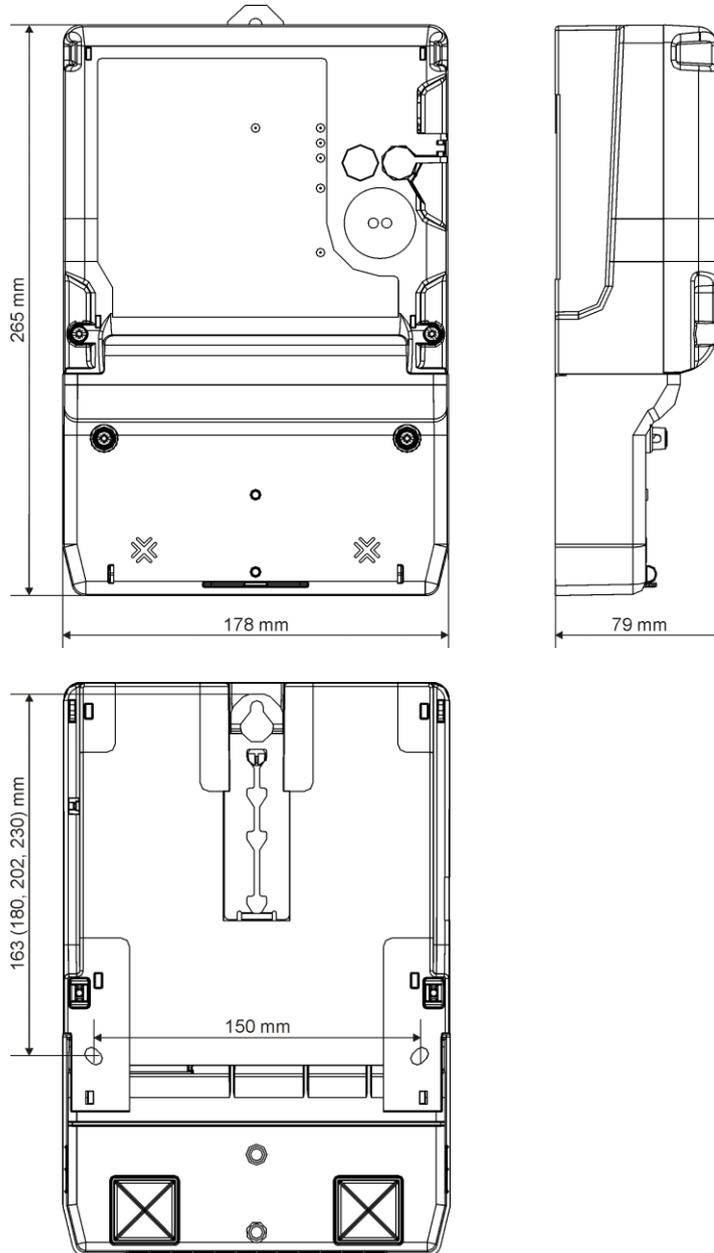
Bild 1: Zählerabmessungen
