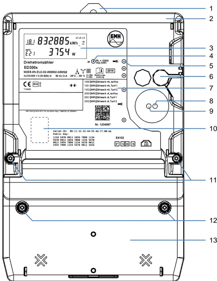
Bild 5: Gehäuse-, Bedien- und Anzeigeelemente
