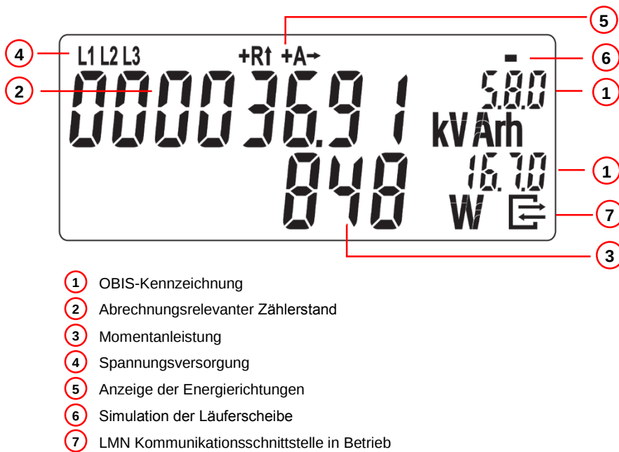
Bild 28: Detaillierte Beschreibung der LCD-Anzeige
