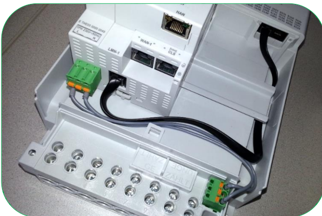
Bild 43: Verbindung SMGw an LMN-1 Stecker
