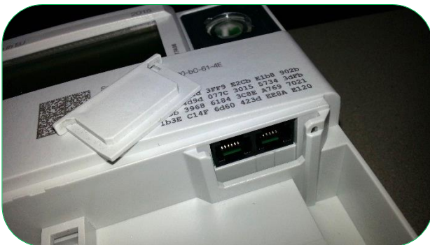
Bild 42: LMN Schnittstelle – Zugang zu RJ-12 Buchsen
