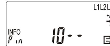
Zur Eingabe der PIN leuchten Sie auf die optische Taste. Nach dem Displaytest (Anzeigeelemente in erste und zweite Zeile werden wechselhaft eingeblendet) erfolgt die PIN-Abfrage.
