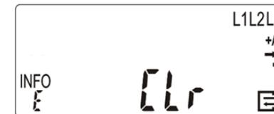
Um den Verbrauch innerhalb eines selbst gewählten Zeitraums zu ermitteln, schalten Sie mit der Taschenlampe die Anzeige solange weiter, bis in der „*INFO-Zeile*“ **E CLr** angezeigt wird. Leuchten Sie dann mit der Taschenlampe min. 5 Sekunden auf die optische Taste, bis die „*INFO-Zeile*“ **E Clr on** anzeigt. Ein weiteres Anleuchten für min. 5 Sekunden startet dann den gewählten Zeitraum.
