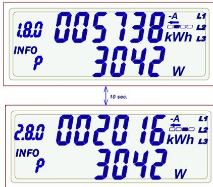
Die Anzeige wechselt alle 10s zwischen importierter (1.8.0) und exportierter (2.8.0) Energie. Die aktuelle Zählrichtung erkennt man am Symbol -A oder +A
